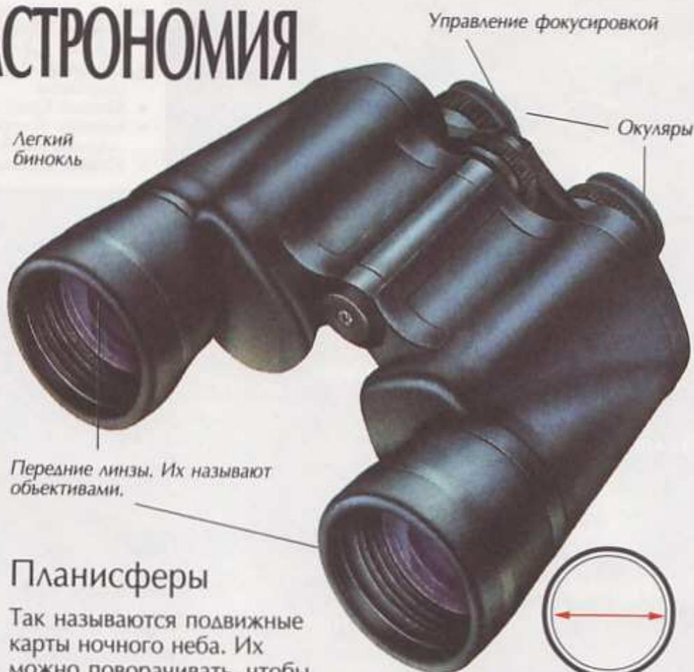
Диаметром линзы называют ее поперечный размер от края до края.
