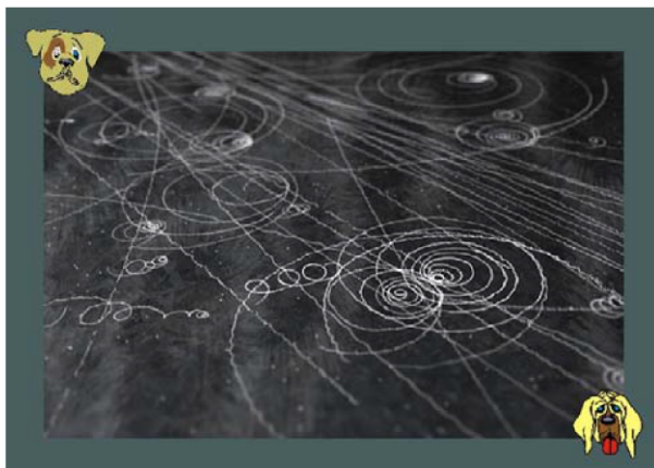
Рис. 2.22. Следы частиц в камере Вильсона
